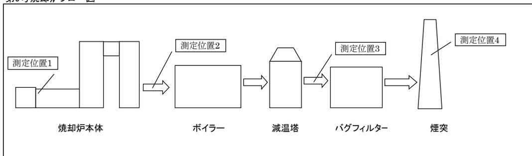
燃焼室中の燃焼ガス温度等[規第十二の七の二 - ロ、規第十二の七の五 - ロ]
